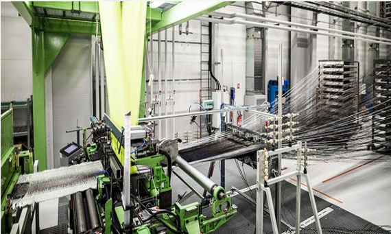
3D-s kompozitokhoz automata Jacquard 2.0 szövőgép
