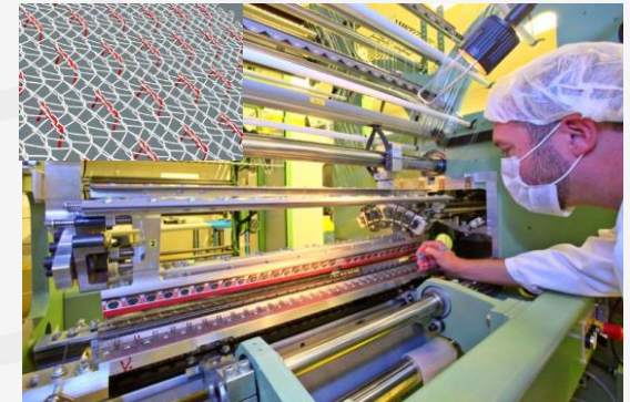
Orvosi eszközöket (pl. hasfali hálót) gyártó lánchurkológép
