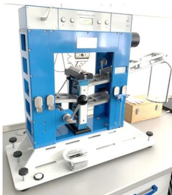
TDM késvágás vizsgálat (FERO) – MSZ EN ISO 13997
