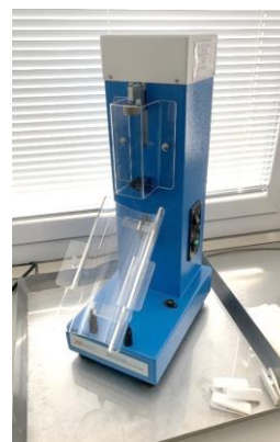
Folyadékadagoló készülék (MIRTA-KONTROL) MSZ EN ISO 6530
