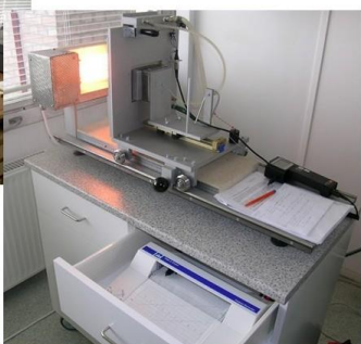
sugárzó hő hatásának vizsgálata
